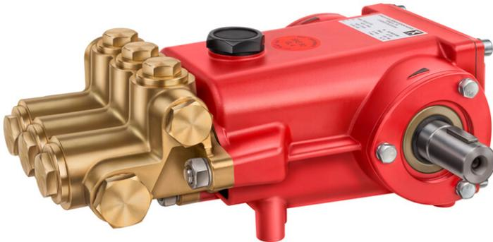
Plungerpumpen sind geeignet zur Förderung von sauberem Wasser (andere Medien erfordern die werksseitige Prüfung und Freigabe). Als Verdrängerpumpen haben Plungerpumpen einen hohen Wirkungsgrad. Pumpen der Baureihe P 30/31 besitzen eine Leckagerückführung für hohe Dichtungsstandzeiten. Besonders langlebiger Antrieb und gute Plungerführung. Diese Baureihe wird unter anderem für Reinigungs- und Abpressanwendungen eingesetzt.
