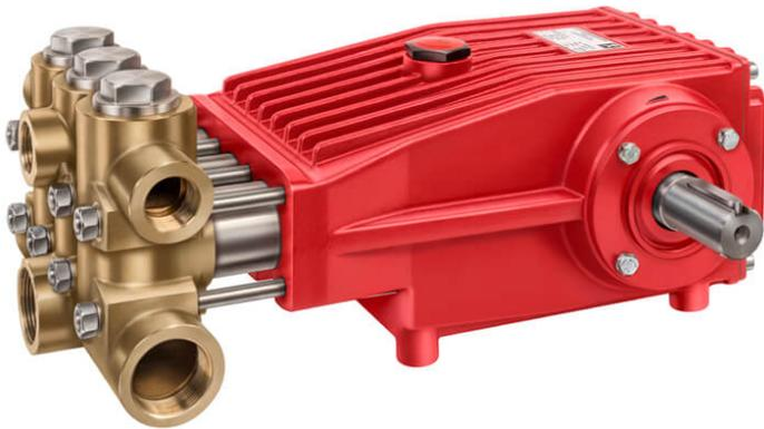
Diese Plungerpumpen sind Sonderausführungen für Heißwasser bis max. 105°C. Als Verdrängerpumpen haben Plungerpumpen einen hohen Wirkungsgrad. Pumpen der Baureihe P 71 DK besitzen eine doppelte Plungerabdichtung aus hochtemperaturbeständiger Kunstfaser und Kühlvorrichtungen zum Kühlen der Dichtungen für verbesserte Dichtungsstandzeiten. Diese Baureihe wird unter anderem für Dampfkesselanlagen eingesetzt.
