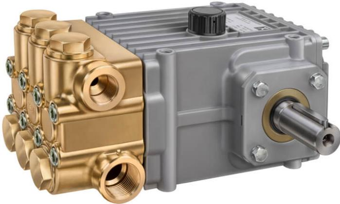
Plungerpumpen sind zur Förderung von sauberem Wasser geeignet (andere Medien erfordern die werksseitige Prüfung und Freigabe). Als Verdrängerpumpen haben Plungerpumpen einen hohen Wirkungsgrad und eine doppelte Plungerabdichtung mit Leckagerückführung. Die Baureihe NP 25 wird unter anderem für Reinigungs- und Abpressanwendungen eingesetzt.
