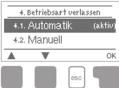
Im Menü "4. Betriebsart" kann der Regler neben dem Automatikbetrieb auch ausgeschaltet oder in einen manuellen Betriebsmodus versetzt werden.
