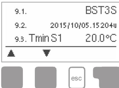
Das Menü "9. Servicewerte" dient im Fehlerfall z.B zur Ferndiagnose durch den Fachmann oder Hersteller.
