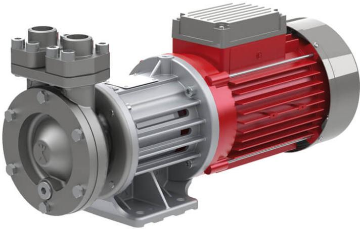
Diese normalsaugenden Peripheralradpumpen mit Magnetkupplung zeichnen sich durch hohen Druck bei geringer Fördermenge und kompakte Bauweise aus. Aufgrund der Magnetkupplung sind sie leakage- und wartungsfrei. Einsatz finden diese unter anderem in Kreisläufen für Flüssigkeiten ohne Feststoffe, wie Kühlkreisläufen oder Temperierungen.
