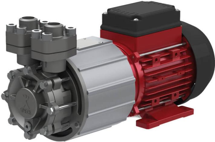
Diese normalsaugenden Peripheralradpumpen mit Magnetkupplung zeichnen sich durch hohen Druck bei geringer Fördermenge und kompakte Bauweise aus. Aufgrund der Magnetkupplung sind sie leakage- und wartungsfrei. Einsatz finden diese unter anderem in Kreisläufen für Flüssigkeiten ohne Feststoffe, wie Kühlkreisläufen oder Temperierungen.
