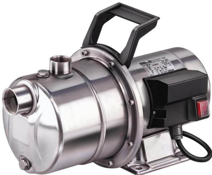
Selbstansaugende Kreiselpumpe, geeignet für reine, wasserähnliche Flüssigkeiten. Ausgestattet mit lebensdauergeschmierten Motorlagern. Wellenabdichtung mittels Gleitringdichtung. Wechselstromausführung mit Ein- und Ausschalter im Klemmkasten, 1,5 m Kabel und Schukostecker.
