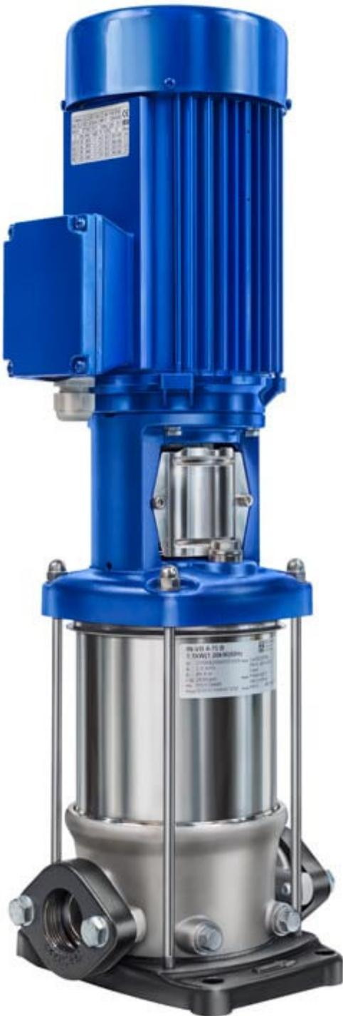
Vertikale, mehrstufige Kreiselpumpen der Baureihe IN-VB sind normalsaugenden Hochdruckkreiselpumpen und zeichnen sich durch einen hohen Wirkungsgrad sowie eine lange Lebensdauer aus. Die Medium berührten Bauteile werden aus Edelstahl 1.4301 bzw. 1.4404 gefertigt. Drehstrommotoren  $\geq 0,75$  kW entsprechen der Energieeffizienzklasse IE3. Höhere Energieeffizienzklassen sind durch unser Baukastensystem kein Problem.
