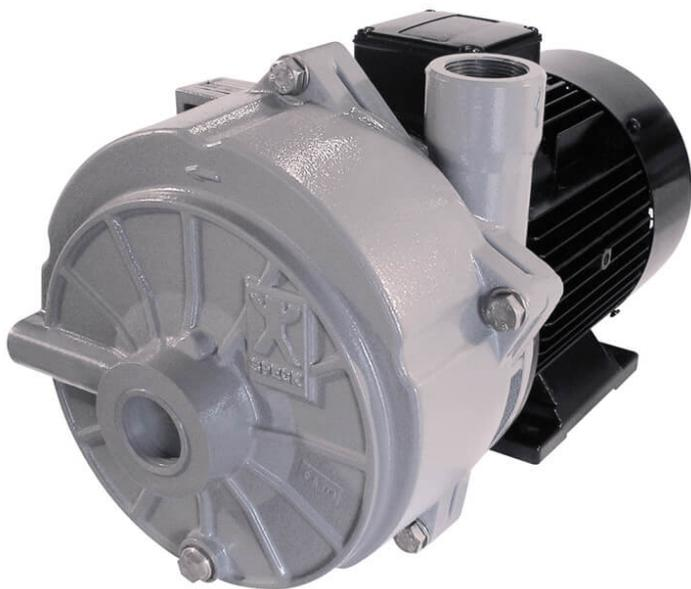
Diese Flüssigkeitsring-Vakuumpumpen sind einstufig mit Steuernabe für eine hohe Flüssigkeitsmitförderung und halten gleichzeitig ein stabiles Saugvermögen. Einsatz finden diese unter anderem in der Kunststoffextrusion.
