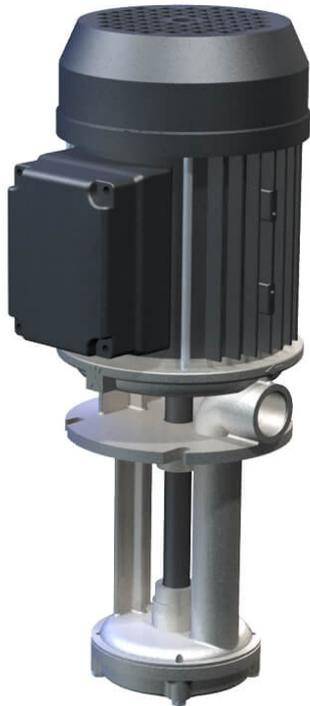
Diese Eintauchpumpen mit Peripheralradlaufrad zeichnen sich durch hohen Druck und dichtunglose, wartungsarme Bauweise aus. Einsatz finden diese unter anderem in Kreisläufen mit Medien ohne Feststoffe, wie z. B. in Temperiergeräten oder Maschinenkühlungen.
