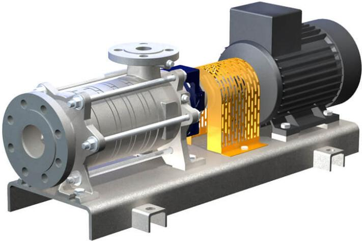
Diese selbstansaugenden, gasmitfördernden Seitenkanalpumpen weisen aufgrund der NPSH-Vorstufe einen sehr niedrigen NPSH-Wert auf, weshalb diese für Anwendungen unter schwierigen Saug- bzw. Zulaufbedingungen zum Einsatz kommen, z. B. als Kesselspeise- oder Kondensatpumpen.
