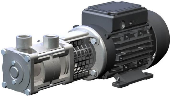
Diese selbstansaugenden Peripheralradpumpen zeichnen sich durch hohen Druck bei geringer Fördermenge und kompakte Bauweise aus. Einsatz finden diese unter anderem in Kreisläufen für wasserähnliche Flüssigkeiten, wie Kühlkreisläufen oder Nachspeisungen.
