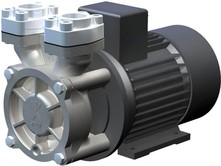
Diese normalsaugenden Peripheralradpumpen zeichnen sich durch hohen Druck bei geringer Fördermenge und kompakte Bauweise aus. Einsatz finden diese unter anderem in Kreisläufen für wasserähnliche Flüssigkeiten, wie Kühlkreisläufen oder Nachspeisungen.
