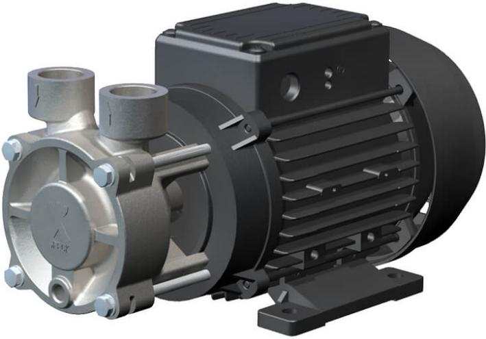
Diese normalsaugenden Peripheralradpumpen zeichnen sich durch hohen Druck bei geringer Fördermenge und kompakte Bauweise aus. Einsatz finden diese unter anderem in Kreisläufen für wasserähnliche Flüssigkeiten, wie Kühlkreisläufen oder Nachspeisungen.
