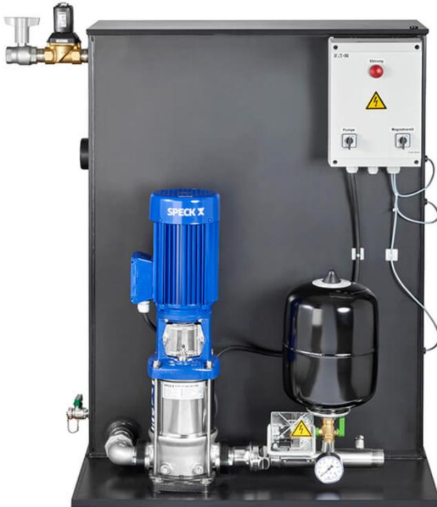
Trinkwasser-Trennstationen verhindern das Rückfließen des Mediums, aus dahinter angeschlossenen Brauchwasserleitungen, in die Trinkwasserleitung und werden bei Feuerlöschanlagen, Beregnungsanlagen, Laborwasseranlagen und in der Landwirtschaft eingesetzt.
