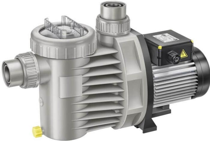
Die selbstansaugenden Messwasserpumpen sind eine Sonderentwicklung mit korrosionsfesten Werkstoffen für die kontinuierliche Entnahme von Messwasser. Die Messwasserpumpen sind aufgrund ihrer selbstansaugenden Fähigkeit und der Blockweise sehr wartungsfreundlich. Spezialverschraubungen mit Bundbuchse sind im Lieferumfang enthalten.
