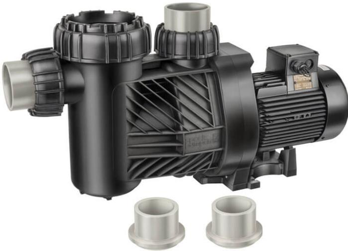
Die Pumpen der Sonderbauform AK entsprechen den Standardvarianten aus unserem BADU-Programm, sind jedoch aufgrund ihrer speziellen Ausführung für den Einsatz in diversen Salzwässern und Problemmedien konstruiert worden. Eventuell austretendes Medium oder auskristallisierende Mineralien und Salze kommen nicht mit dem Motor und dem Lager in Verbindung. Hierdurch werden erheblich längere Betriebszeiten gegenüber den Standardvarianten für diese Einsatzgebiete ermöglicht.
