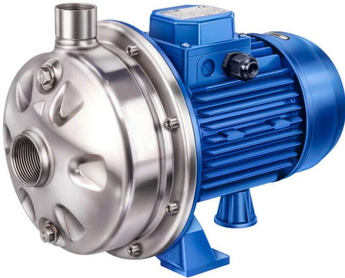
Kreiselpumpen der Baureihe VGX / 2 VGX sind ein- bzw. zweistufige Pumpen in Blockbauweise. Die normalsaugenden Kreiselpumpen zeichnen sich durch eine kompakte Bauform sowie eine lange Lebensdauer aus. Die Medium berührten Bauteile werden aus Edelstahl 1.4301 gefertigt.
