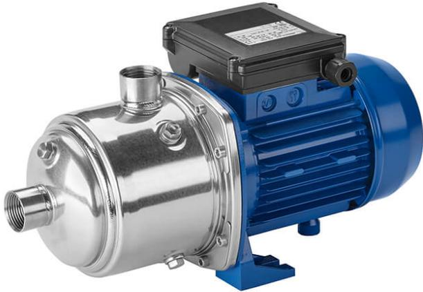
Blockpumpe mit oberflächengekühltem Motor, verlängerter Motorwelle zur Aufnahme der Laufräder, Wellendichtung durch Gleitringdichtung, ausgelegt für Dauerbetrieb.
