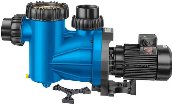
Die Pumpen der Sonderbauform AK entsprechen den Standardvarianten aus unserem BADU Programm, sind jedoch aufgrund ihrer speziellen Ausführung für den Einsatz in diversen Salzwässern und Problemmedien konstruiert worden. Eventuell austretendes Medium oder auskristallisierende Mineralien und Salze kommen nicht mit dem Motor und dem Lager in Verbindung. Hierdurch werden erheblich längere Betriebszeiten gegenüber den Standardvarianten für diese Einsatzgebiete ermöglicht.
