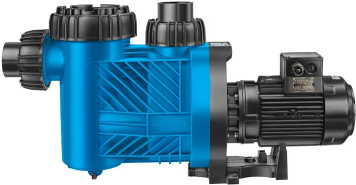
Die Pumpen der Sonderbauform AK entsprechen den Standardvarianten aus unserem BADU Programm, sind jedoch aufgrund ihrer speziellen Ausführung für den Einsatz in diversen Salzwässern und Problemmedien konstruiert worden. Eventuell austretendes Medium oder auskristallisierende Mineralien und Salze kommen nicht mit dem Motor und dem Lager in Verbindung. Hierdurch werden erheblich längere Betriebszeiten gegenüber den Standardvarianten für diese Einsatzgebiete ermöglicht.
