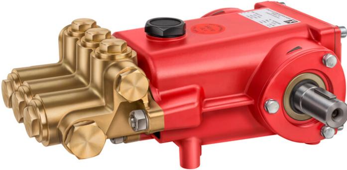
Hochdruckplungerpumpen der Baureihe P 30 D sind oszillierende Verdrängerpumpen, die über einen hohen Wirkungsgrad verfügen. Die solide und bewährte Bauart ermöglicht den Einsatz in Anwendungsgebieten mit hohen Anforderungen. Diese Kesselspeisepumpen kommen in verschiedensten Gebieten zum Einsatz. Sie erzeugen zuverlässig einen hohen Flüssigkeitsdruck mit Wasser bei Temperaturen bis 105 °C.
