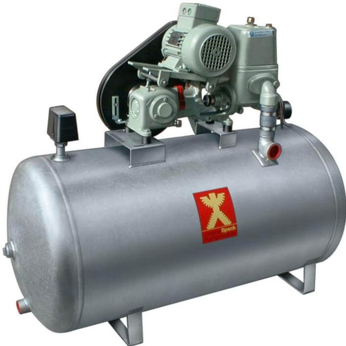
Das werkseitig zusammengebaute Pumpwerk ist typgeprüft und besteht aus folgenden Teilen: Pumpmeister-Kolbenpumpe mit eingebautem Membransicherheitsventil (baumustergeprüft), Elektromotor, verzinktem Druckkessel, eingestelltem Druckschalter von 2,0 bis 3,5 bar, Manometer, Belüftungsautomat, vollkommen geschlossener Riemenschutz aus Kunststoff für Ihre Sicherheit. Ein Motorschutzschalter ist bauseits vorzusehen.
