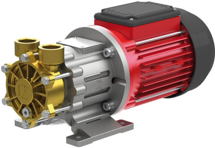
Diese normalsaugenden Peripheralradpumpen mit Magnetkupplung zeichnen sich durch hohen Druck bei geringer Fördermenge und kompakte Bauweise aus. Aufgrund der Magnetkupplung sind sie leakage- und wartungsfrei. Einsatz finden diese unter anderem in Kreisläufen für Flüssigkeiten ohne Feststoffe, wie Kühlkreisläufen oder Temperierungen.
