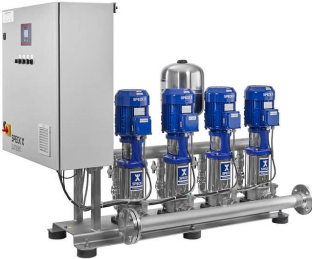
Druckerhöhungs-Anlagen der Baureihe Multicell sind je nach Bedarfsfall mit 2 bis 6 Pumpen ausgestattet. Die vollautomatischen Druckerhöhungs-Anlagen sind kompakt, geräuscharm und werden anschlussfertig verdrahtet und komplett verrohrt ausgeliefert. Alle Aggregate besitzen eine vollautomatische Pumpensteuerung. Die Druckerhöhungs-Anlage ist mit einer Drehzahlregelung ausgestattet.
