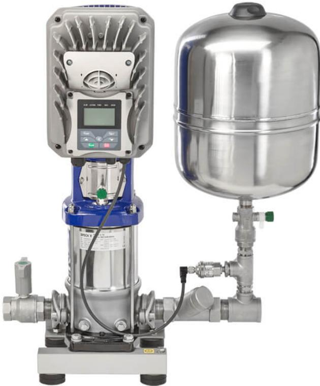
Druckerhöhungs-Anlagen der Baureihe Aquacell enthalten eine normalsaugende Stufenkreislumppe. Die vollautomatischen Druckerhöhungs-Anlagen sind kompakt, geräuscharm und werden anschlussfertig verdrahtet und komplett verrohrt ausgeliefert. Alle Aggregate besitzen eine vollautomatische Pumpensteuerung. Die Druckerhöhungs-Anlage ist mit einer Drehzahlregelung ausgestattet.
