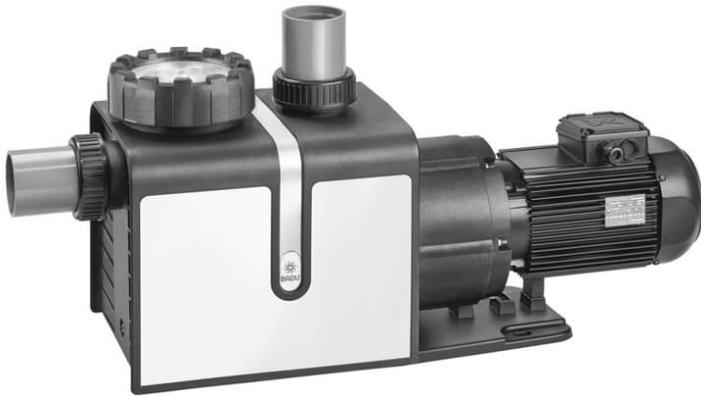
Die erste dichtungslose Schwimmbadpumpe mit einer Magnetkupplung anstatt Gleitringdichtung. Die Motorleistung wird berührungslos und verschleißfrei über eine Magnetkupplung durch den Spalttopf auf das Laufrad übertragen. Die Pumpe verfügt über eine wartungsfreie Konstruktion und kühlt sich von selbst mittels eines einzigartigen Zirkulationssystem.
