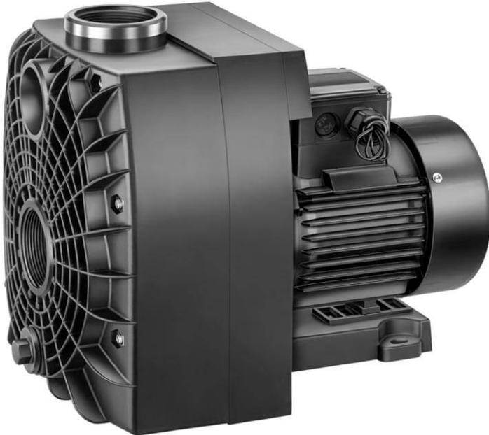
Die normalsaugende Pumpe steht unterhalb des Wasserspiegels und ist somit oft eine gute Wahl für Pool-Attraktionen und Whirlpools. Als mittelgroße Jet-Pumpe sowie als Zusatz-Pumpe ist die BADU 43 ideal für Becken mit einer Größe von 30 bis 150m<sup>3</sup>. Außerdem dient sie zur Unterstützung im Wasserkreislauf.
