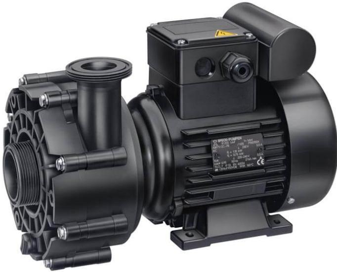
Die BADU 21er-Pumpen sind für spezielle Herausforderungen in Badewannen, Whirlpools, Gegenstromanlagen und Reinigungsgeräten konzipiert. Alle Modelle der Baureihe sind normalsaugende Umwälzpumpen, welche somit keine Luft mitfördern können. Diese Schwimmbadpumpen sind generell unterhalb des Wasserspiegels aufzustellen, damit das Badewasser selbstständig zufließen kann.
