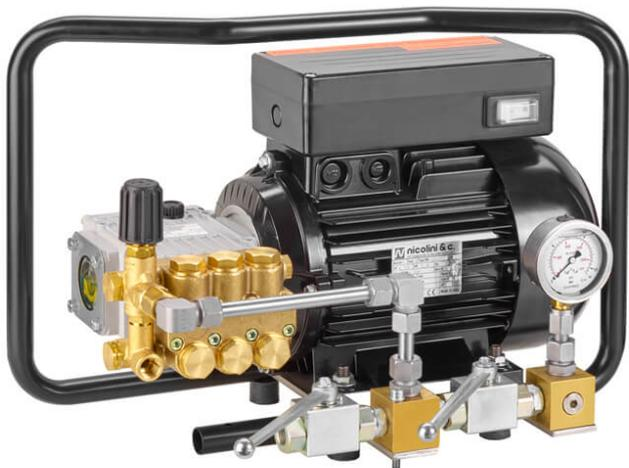
Abpressaggregate der Baureihe NP 10 sind speziell für Druckprüfungen ausgelegte Hochdruckaggregate, wie sie z. B. für Rohrleitungsdruckprüfungen eingesetzt werden. Mit dem angebauten Tragebügel, dem per Handrad verstellbaren Überströmventil und den Absperrhähnen (1 x „Druck“, 1 x „Entlastung“) sind die Abpressaggregate NP 10 leicht zu transportieren und universell einsetzbar. Eine Anschlussmöglichkeit für einen Druckschreiber Rp 1/4“ sowie ein Manometer sind vorhanden.
