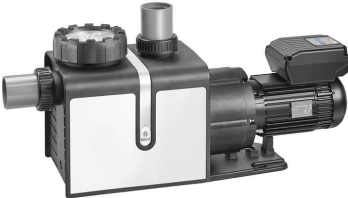
Die erste dichtungslose Schwimmbadpumpe mit einer Magnetkupplung anstatt Gleitringdichtung, plus einem regelbarem PM-Motor. Die Motorleistung wird berührungslos und verschleißfrei über eine Magnetkupplung durch den Spalttopf auf das Laufrad übertragen. Die Pumpe verfügt über eine wartungsfreie Konstruktion sowie einen energieeffizienten Synchron-Kompaktantrieb. Programmierbar von 2000 min<sup>-1</sup> bis 3000 min<sup>-1</sup>.
