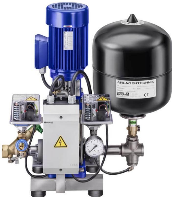
Druckerhöhungsanlagen der Baureihe Aquacell enthalten eine normalsaugende Stufenkreiselpumpe. Die vollautomatischen Druckerhöhungsanlagen sind kompakt, geräuscharm und werden anschlussfertig verdrahtet und komplett verrohrt ausgeliefert. Alle Aggregate besitzen eine vollautomatische Pumpensteuerung.
