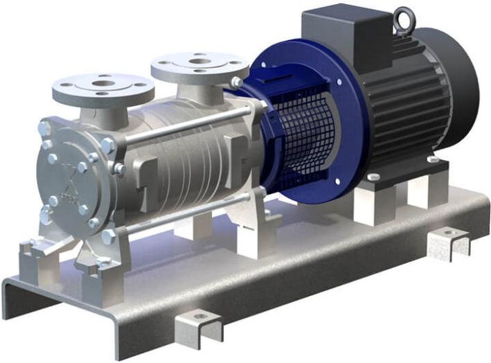
Diese selbstansaugenden, gasmitfördernden und magnetgekuppelten Seitenkanalpumpen dienen zur Förderung von Flüssigkeiten, ohne Feststoffe, und können ebenso in Heißwasseranwendungen oder Anwendungen mit großer Saughöhe eingesetzt werden, z. B. als Kesselspeise- oder Kondensatpumpen. Aufgrund der Magnetkupplung entfällt die Wellendichtung, deshalb kann die Pumpe auch für schwierige Medien eingesetzt werden.
