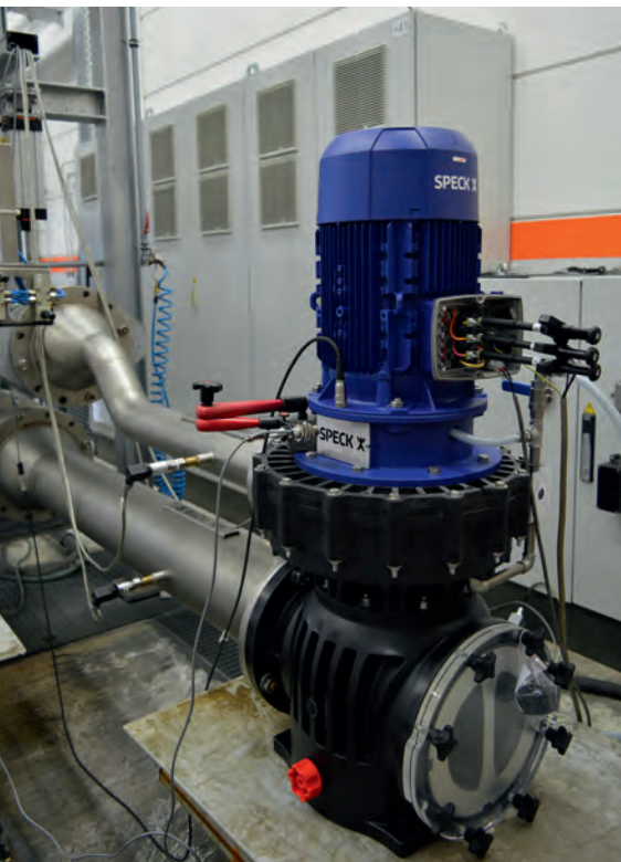
Auf dem Prüfstand hat jede Pumpe vor Auslieferung einige Tests zu bestehen, bevor sie zum Versand kommt.
