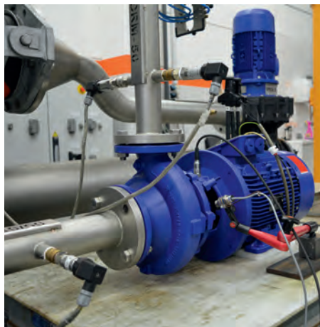
Auf dem Prüfstand hat jede Pumpe vor Auslieferung einige Tests zu bestehen, bevor sie zum Versand kommt.
