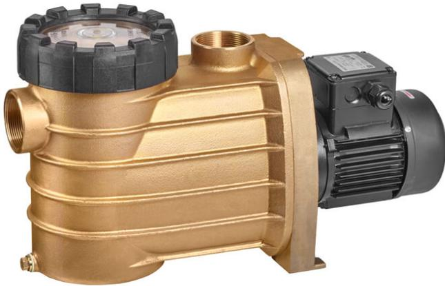
Die massiven BADU Bronze Schwimmbadpumpen sind ausschließlich aus hochwertiger Bronze gefertigt - ohne Zusätze von Zink oder Blei. Die Pumpen sind somit salzwasserbeständig und ermöglichen einen problemlosen Filterbetrieb. Die langlebigen Pumpen für große Schwimmbäder bieten so eine ganz besonders hohe Korrosionsbeständigkeit in Becken mit einer Größe von 30 bis 150 m<sup>3</sup>.
